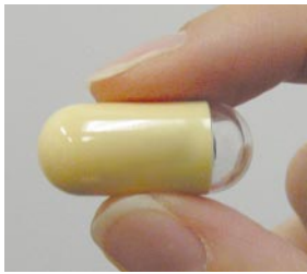
図1 カプセル内視鏡(実寸) 口から飲み込むだけで、苦痛なく小腸内が撮影できる
